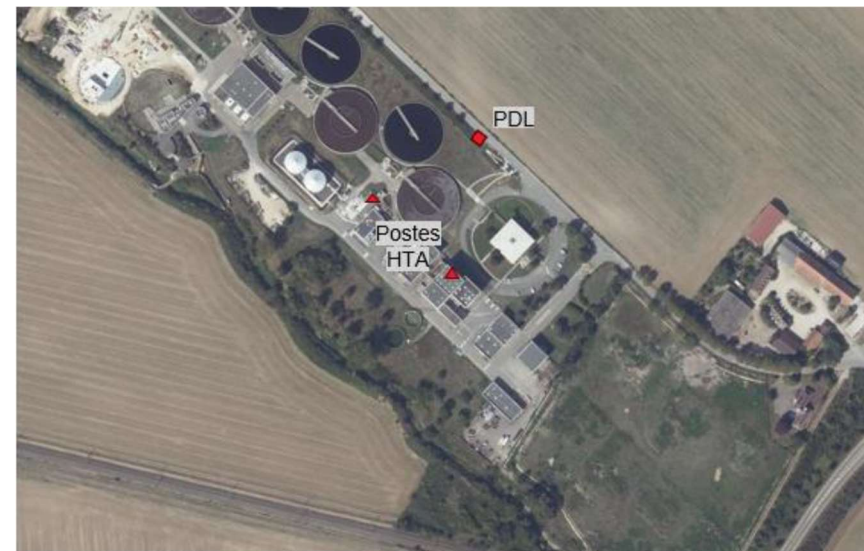
Figure 15 : Postes HTA et PDL pour le raccordement envisagé (source : Greenbirdie et Odivea)
